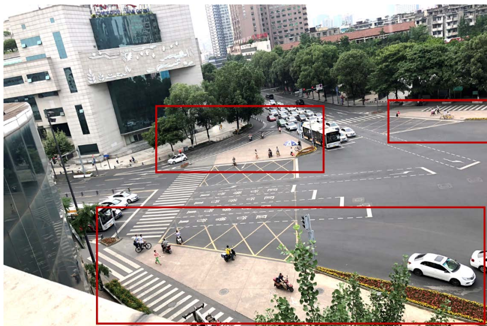
图 1.10 交叉口渠化交通岛设施图
